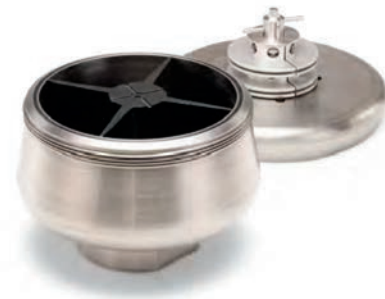
Зональный ротор JCF-Z с сердечником для переориентации градиента, предназначенный для высокопроизводительного выделения вирусов и клеток
