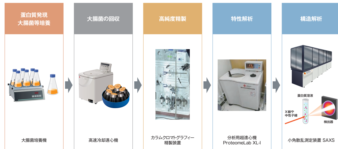
図1 遺伝子組換え蛋白質の構造解析(AUC-SAS法)のための実験フロー
