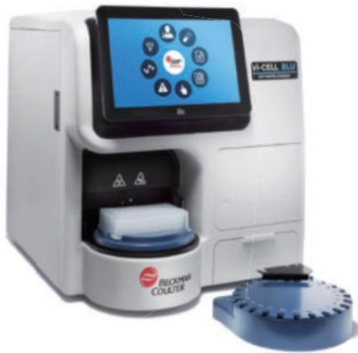
Vi-CELL BLU はバイオリジクス業界で広く使用されている細胞の生死判定を行うセルカウンターです。細胞の生死判定、計数を行う方法として広く受け入れられているトリパンブルー染色法により、染色から機器の洗浄までの工程を自動化し細胞の計数を行います。
